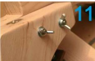
Beim Lösen der Schrauben muss sich der Bogen in dem Langloch hin und her schieben lassen. Wenn nötig ein wenig Seife in die Löcher
